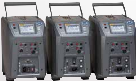
Puits de métrologie de terrain 9142, 9143, 9144
