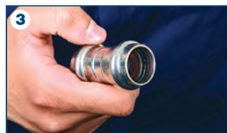
3- Vérification du joint torique
