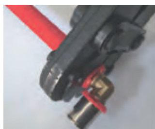
3. Placez le raccord dans la mâchoire. Monter les mâchoires adaptées au profil du raccord sur la pince à sertir
