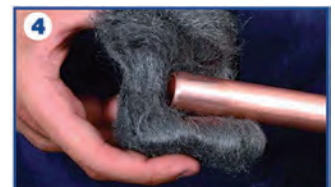
4 - Nettoyer à l'extérieur du tube
