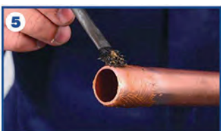
5 - Appliquer le décapant
