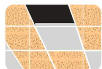
**Encastrement dans un plafond suspendu.** Ce mode est toléré si la cassette fixée indépendamment, ne repose pas directement sur les ossatures.
