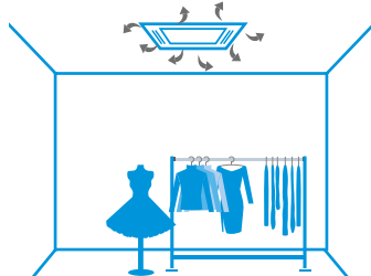
Distribution de l'air avec un filtre encrassé
