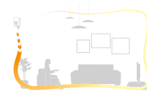
En mode chauffage, les volets dirigent l'air vers le bas (débit d'air vertical).
