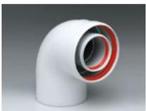
Coude M-F à 90° concentrique, Ø 80/125 mm, extérieur en PVC, intérieur en aluminium
