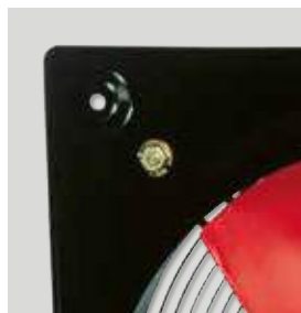
Résistance à la corrosion Platine, support moteur et grille de protection traités par cataphorèse et protégés par une peinture polyester noire. Visserie inoxydable.
