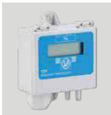
TDP-S / TDP-D / TDP-PI Sondes de pression. Adaptées pour contrôler la pression dans les systèmes de ventilation en pression constante. Permettent la lecture de la différence de pression entre deux points de fonctionnement et de la transformer en signal électrique apte pour les différents appareils de contrôle.
