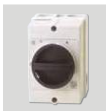
COM D/S Commutateur \Delta/\Delta Permet d'obtenir une seconde vitesse quand il est raccordé à un moteur 3-400 ou 3-400/690, 1 vitesse, acceptant la variation de tension et raccordé à un réseau 3-400V.
