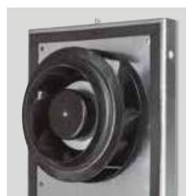
Turbine à réaction Évite l'accumulation des poussières, équilibre dynamiquement. Turbines en plastique pour les tailles 180 et 200, et en aluminium à partir de la taille 225.
