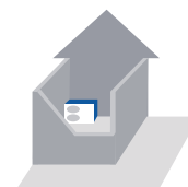
PAC placée dans une cour intérieure : +9 dB(A)
